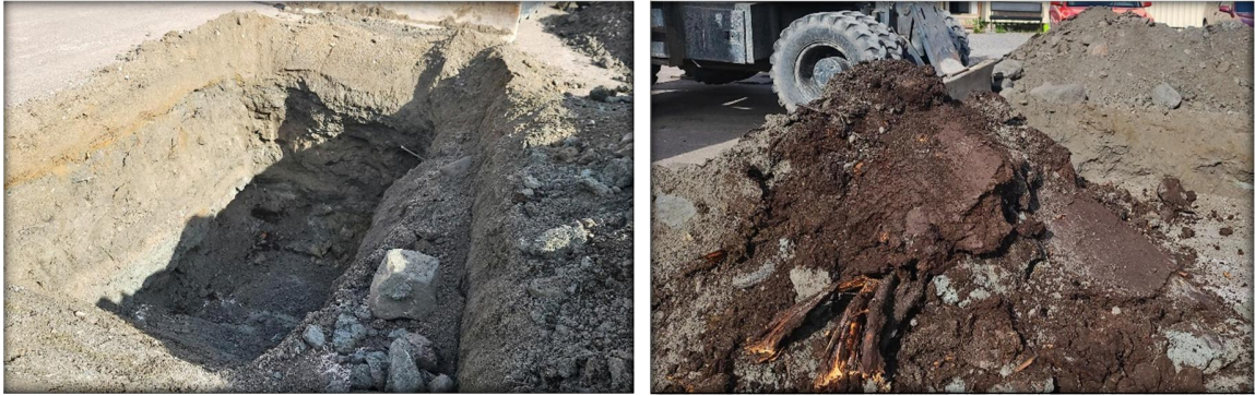
Kuva 4-3. Koekuoppa KK5 kaivettiin kiveen saakka. Koekuopan KK6 pohjalta suon pinnan orgaanista ainesta.
