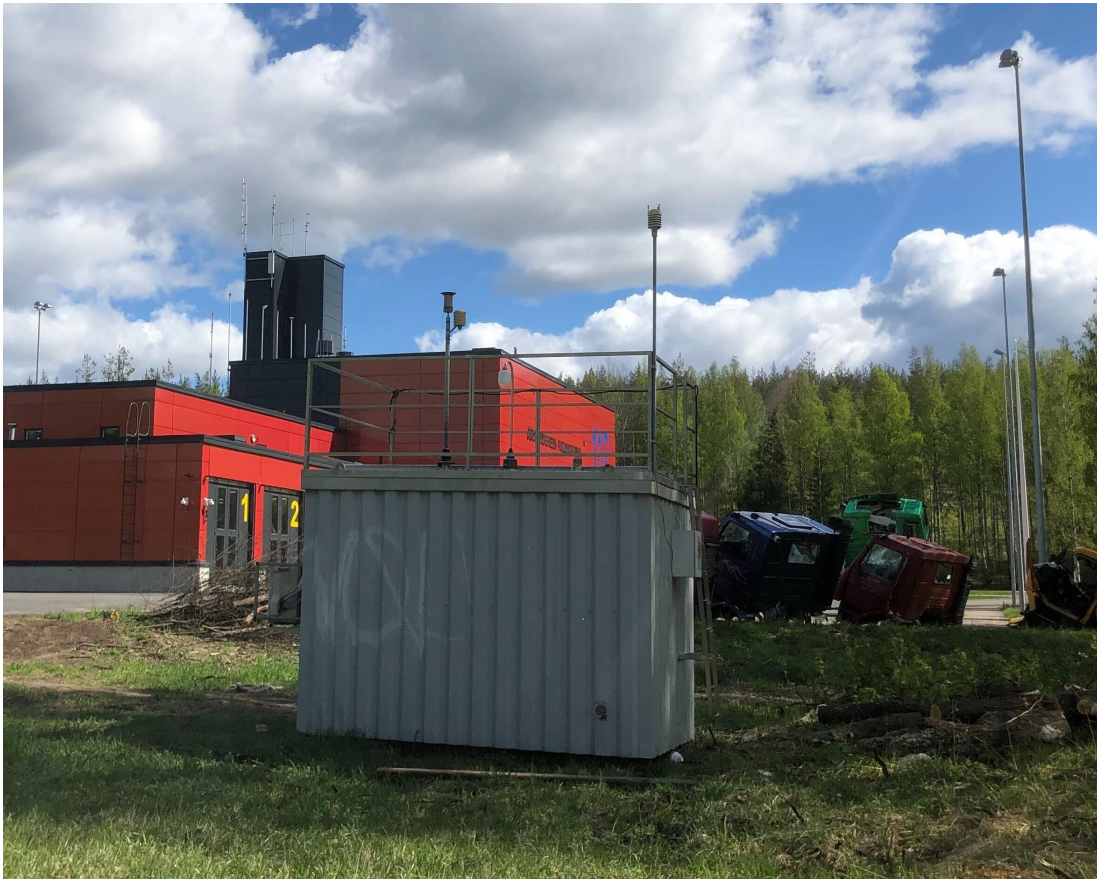
Kuva 21. Ilmanlaadun mittausasema Äänekosken paloaseman pihan laidalla. Ulkoilma imetään mittalaitteisiin kontin katolla sijaitsevien näytteenottimien läpi. Lisäksi katolla on säämittausanturi. Valokuva: Matias Saunamäki.
