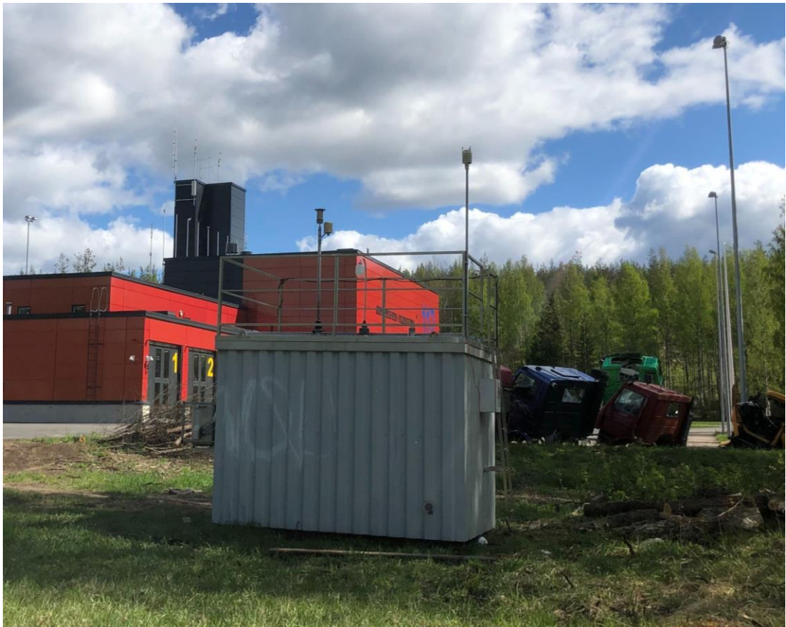
Kuva 20. Ilmanlaadun mittausasema Äänekosken paloaseman pihan laidalla. Ulkoilma imetään mittalaitteisiin kontin katolla sijaitsevien näytteenottimien läpi. Lisäksi katolla on säämittausanturi. Valokuva: Matias Saunamäki.
